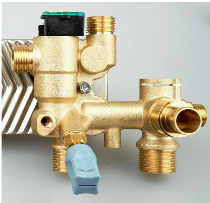
CHI-11系列进水阀组主要实现具有零冷水功能的壁挂炉采暖和卫浴系统信号触发的功能。一般通过霍尔传感器和流量传感器来实现开关信号和比例曲线信号。同时提供系统的补水功能，在阀体上可以预留温度传感器，膨胀水箱，安全泄压阀，循环水泵，零冷水循环管，板式换热器等连接的接口。
