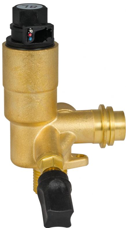
CHIT-01系列进水阀组主要实现套管式壁挂炉采暖和卫浴系统信号触发的功能。一般通过霍尔传感器和流量传感器来实现开关信号和比例曲线信号。同时提供系统的补水功能，在阀体上可以预留旁通管，循环水泵等连接的接口。
